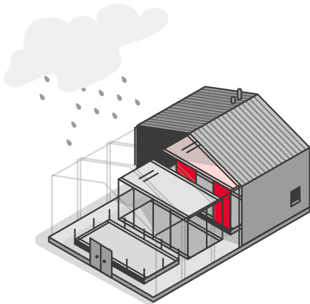
Complete modules gebouwd onder geconditioneerde omstandigheden
